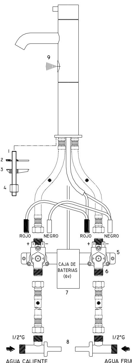
**ESQUEMA DE CONEXIONES
